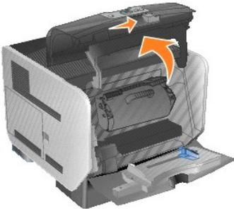
4. Поднимите и извлеките картридж из принтера.
