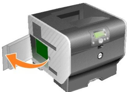
**⚠ ПРЕДУПРЕЖДЕНИЕ.** Дополнительные платы могут выйти из строя под воздействием статического электричества. Дотроньтесь до какого-нибудь металлического предмета, например корпуса принтера, прежде чем дотронуться до дополнительной платы.
