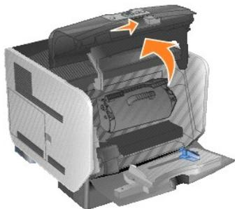
4. Поднимите и извлеките картридж из принтера.
