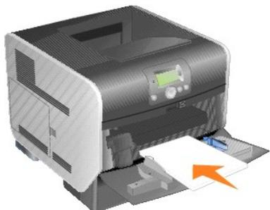
4. Сдвигайте боковую направляющую внутрь лотка до неплотного прилегания к краю материала для печати.
