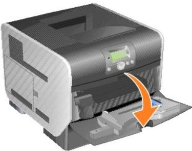
2. Передвиньте вправо защелку фиксатора и откройте переднюю верхнюю крышку принтера.
