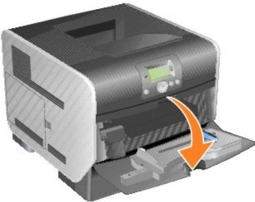
2. Поднимите и откройте крышку разъема устройства подачи конвертов.
