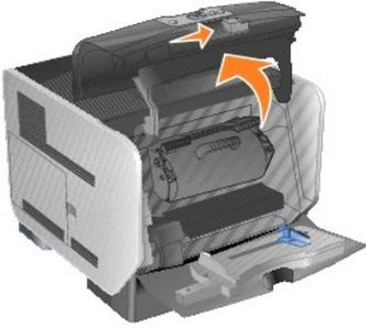
3. Поднимите и извлеките картридж из принтера.
