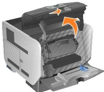
3. Поднимите и извлеките картридж из принтера.
