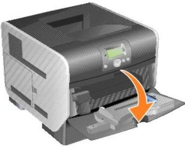
3. Передвиньте вправо защелку фиксатора и откройте переднюю верхнюю крышку принтера.
