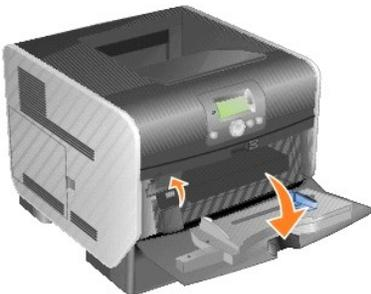
3. Совместите язычки устройства подачи конвертов с гнездами на обеих сторонах принтера и аккуратно вставьте устройство подачи конвертов в
