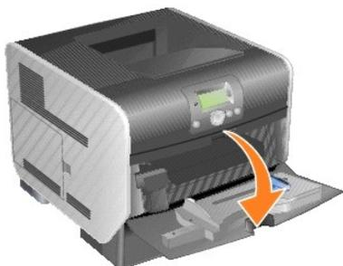
2. Передвиньте вправо защелку фиксатора и откройте верхнюю переднюю крышку принтера.
