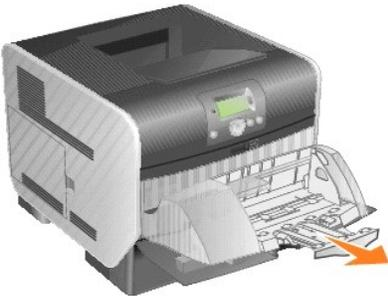
2. Поднимите прижим конвертов назад к принтеру. Он фиксируется в этом положении.
